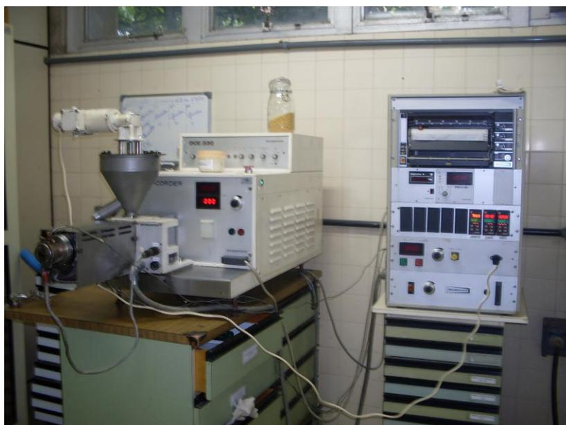
**Figura 6** Extrusor monorosca, marca Brabender, modelo DSE 20 DN (Duisburg, Alemanha)
