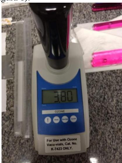
**Figura 6.** Fotômetro para monitoramento da concentração de ozônio na solução
