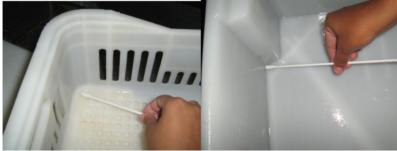
Figura 6. Coleta de amostra por swab para análise microbiológica da superfície dos monoblocos utilizados na produção de filé de peixe congelado
