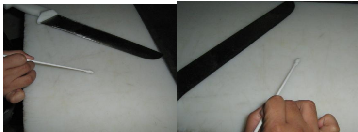
Figura 7. Coleta de amostra por swab para análise microbiológica da superfície da mesa de evisceração utilizada na produção de filé de peixe congelado
