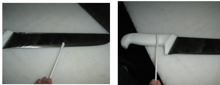
Figura 5. Coleta de amostra por swab para análise microbiológica da superfície das facas utilizadas na produção de filé de peixe congelado.
