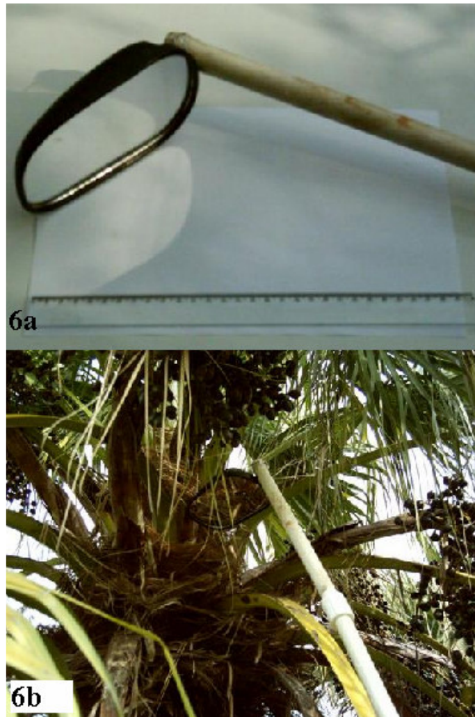
Figura 6. 6a - Estrutura de pvc utilizada para observar o interior dos ninhos; 6b - observação do interior de um ninho com o auxílio do espelho.
