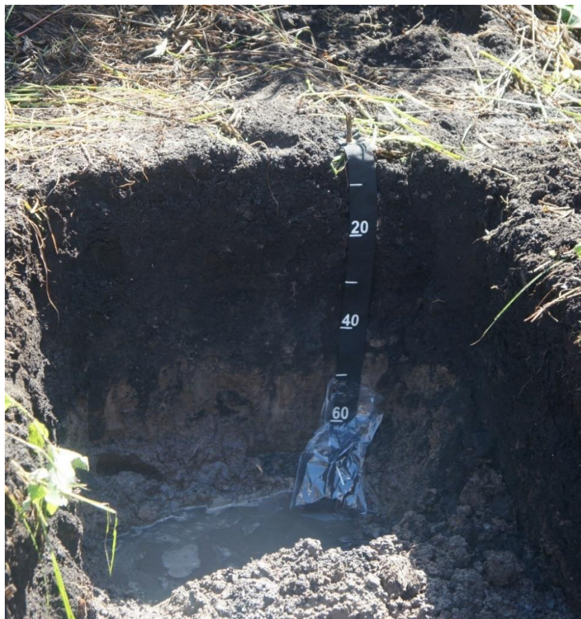
Figura 22. Perfil 4. Organossolo Tiomórfico Sáprico típico, localizado em área de cultivo de mandioca ( Manihot esculenta ) no município do Rio de Janeiro.
