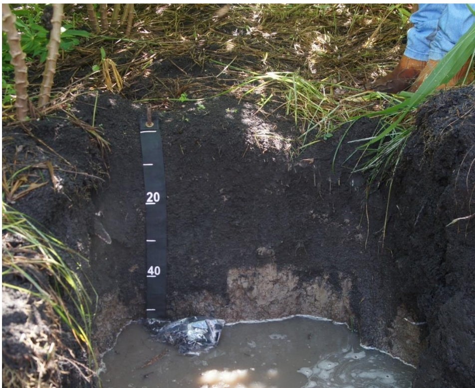
Figura 23. Perfil 5. Organossolo Tiomórfico Sáprico típico, localizado em área de cultivo de mandioca ( Manihot esculenta ) no município do Rio de Janeiro.
