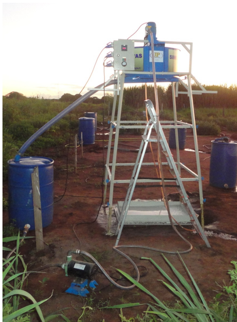
Figura 1. Vista geral do simulador de chuvas InfiAsper. (Foto Wilk Sampaio de Almeida).
