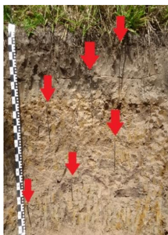
Figura 13. Disposição das barras de ferro no P4.
