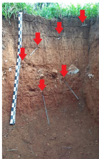
Figura 45. Disposição das barras de ferro no P9.
