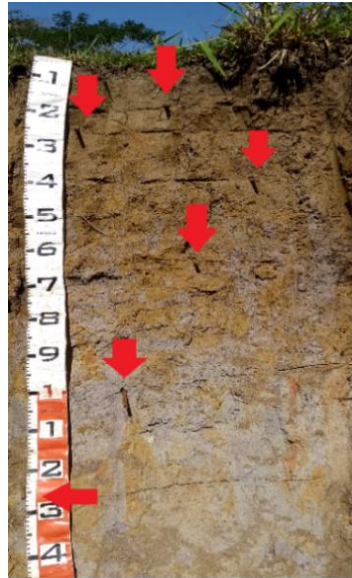
Figura 55. Disposição das barras de ferro no P1.
