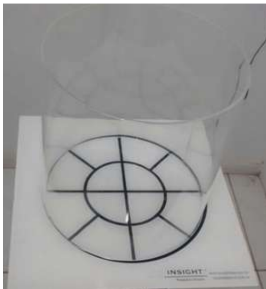
Figura 15: Aparato para realização do teste do campo aberto.
