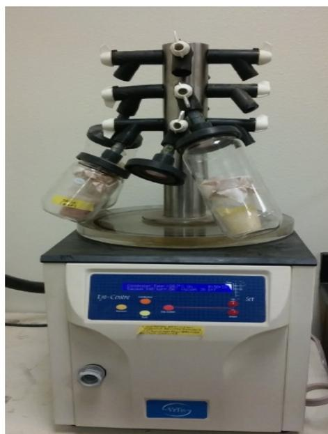
**Figura 2.** Aparelho liofilizador com as amostras de tanino condensado purificado das leguminosas forrageiras tropicais. Fonte: Arquivo Pessoal
