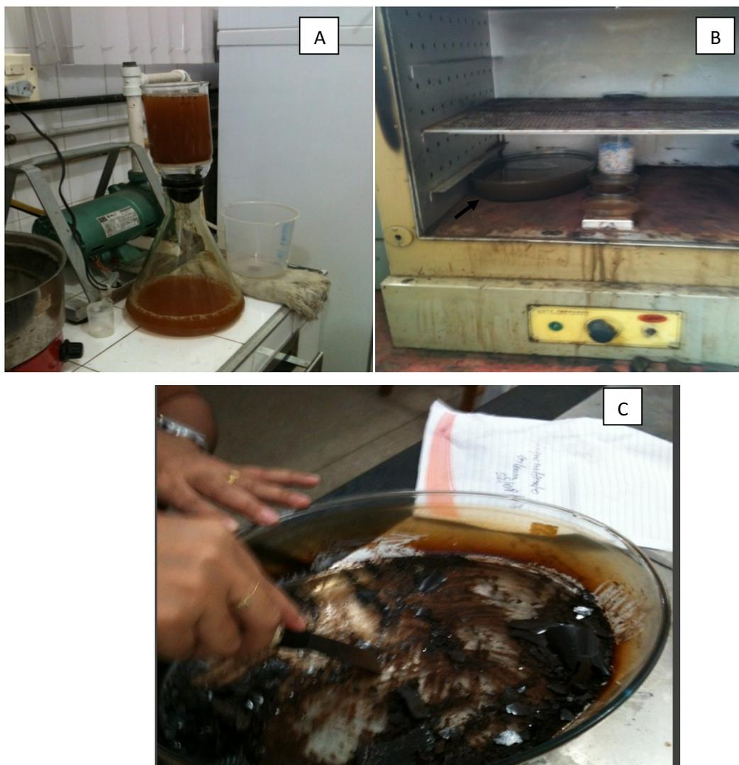
**Figura 1.** A- Material sendo filtrado em cadinho de vidro sinterizado após passagem pelo autoclave. B- Material em bandejas de vidro e levado a estufa 103° ± 2°C por 8 horas, para uma secagem prévia do extrato. C- Após secagem o tanino é raspado e triturado em pó. Fonte: Arquivo Pessoal
