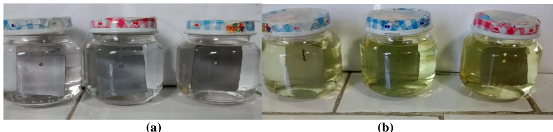
Figura 49: Ensaio de perda de massa, sem inibidor (a) e com inibidor (b) em superfície de aço carbono AISI 1020 na presença de HCl 0,5 mol L -1 .
